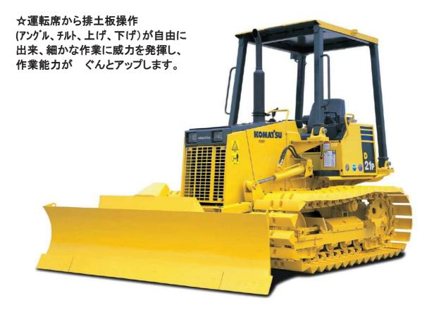
●機体質量3t以上の建設機械の運転には「車両系建設機械運転技能 講習終了証」の取得が必要です。(整地・運搬・積込用及び掘削用)
